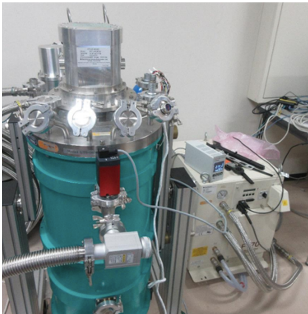
図 4.1 パルスチューブ冷凍機クライオスタットとコンプレッサー
