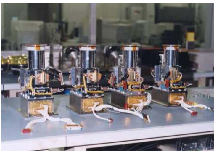
図 2.7: XIS 検出器の外観 (The Suzaku Technical Description より)
