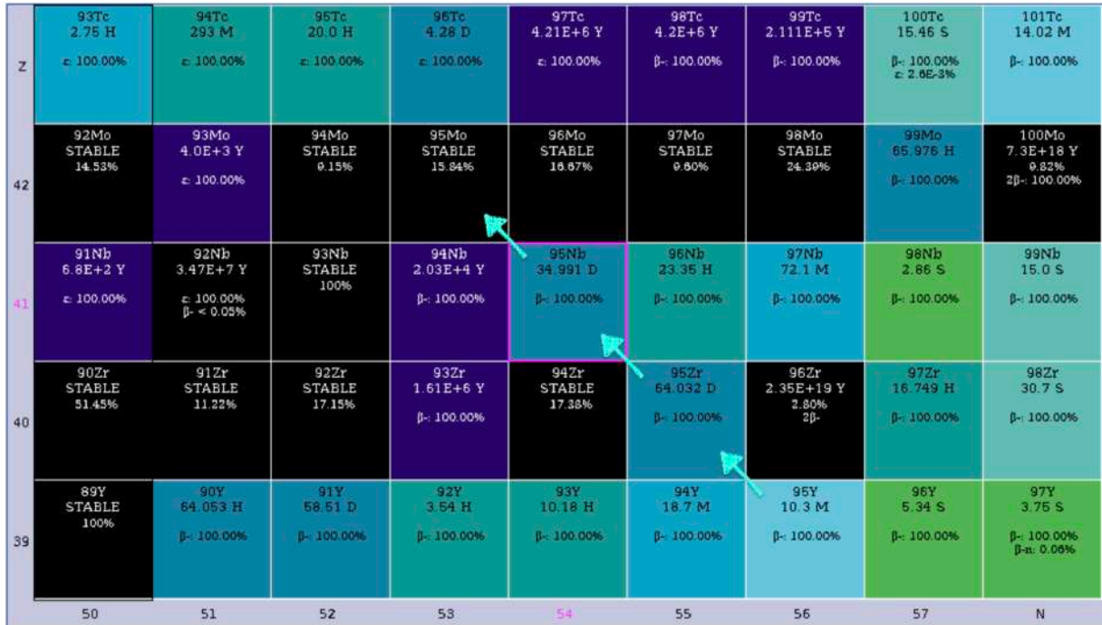
図 7.1 95 Nb(765.8 keV) の崩壊経路。核図表に各元素の半減期と崩壊タイプを記述している (NuDat2)。各元素の色は半減期を示しており、図 (1.1) の右下パネルで示されている。水色矢印は β 崩壊、赤色矢印は α 崩壊を示している。
